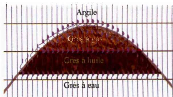
Fig. 2 - section sismique à zéro offset dans un cas d'un anticlinal imbibé d'hydrocarbures
