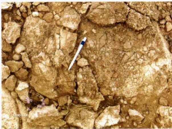
Photo 4 - Aspect des brèches sur les pentes. Notez la fissuration des éléments de la brèche. Aspect of the breccias in the slope. Note the fissuring of the elements of the breccia.
