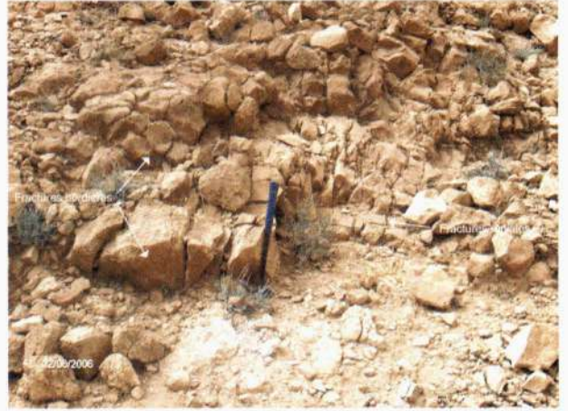
Photo 5 - Fracturation radiale, sub-verticale des calcaires de direction NS.
